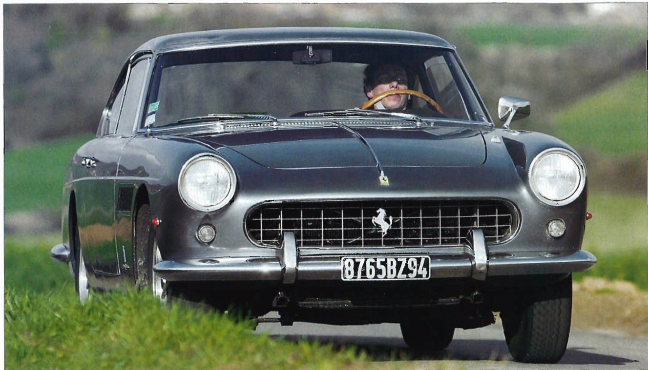
Les gros projecteurs Marchal sont bordés d'un mince filet chromé affleurant. Les prototypes de la 250 GTE étaient dotés d'un cerclage plus ordinaire.
